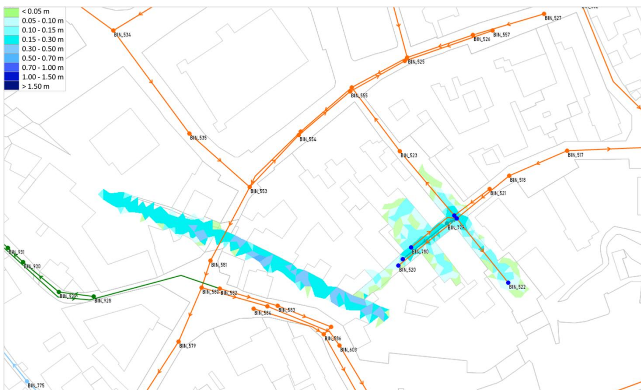
Figura 59 - Allagamenti nella zona di via Cavour e via Invernizzi per lo scenario di simulazione con TR=100anni.
