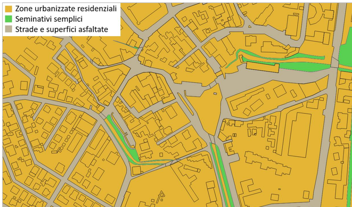
Figura 17 - Mappa aree a differente scabrezza implementate nel modello bidimensionale.
