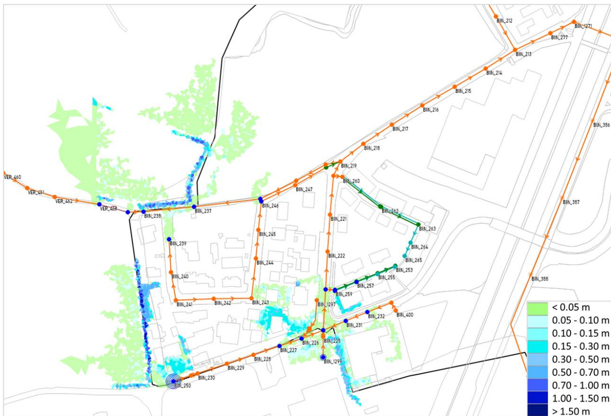
Figura 27 - Allagamenti nella zona di via Archimede, via Torricelli e via Ferraris per lo scenario di simulazione con TR=10 anni.
