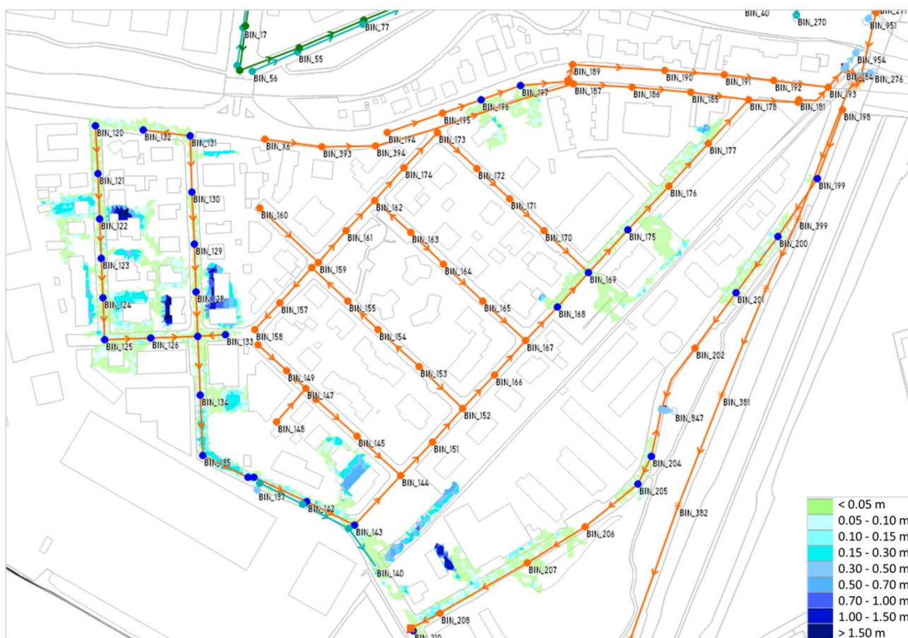
Figura 56 - Allagamenti nella zona via da Vinci, via Volta, via Pitagora e via Roma per lo scenario di simulazione con TR=100 anni.
