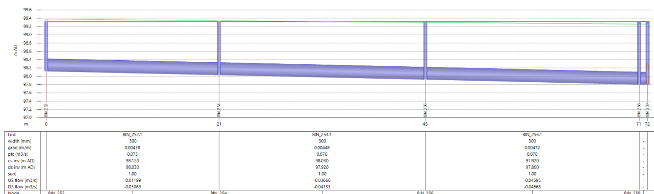
Figura 32 - Profilo idraulico su via Ferraris (252 a 259), allagamenti alle camerette 256, 258 e 259. Scenario di simulazione con TR=10 anni.
