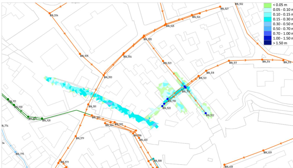
Figura 51 - Allagamenti nella zona di via Cavour e via Invernizzi per lo scenario di simulazione con TR=150 anni.
