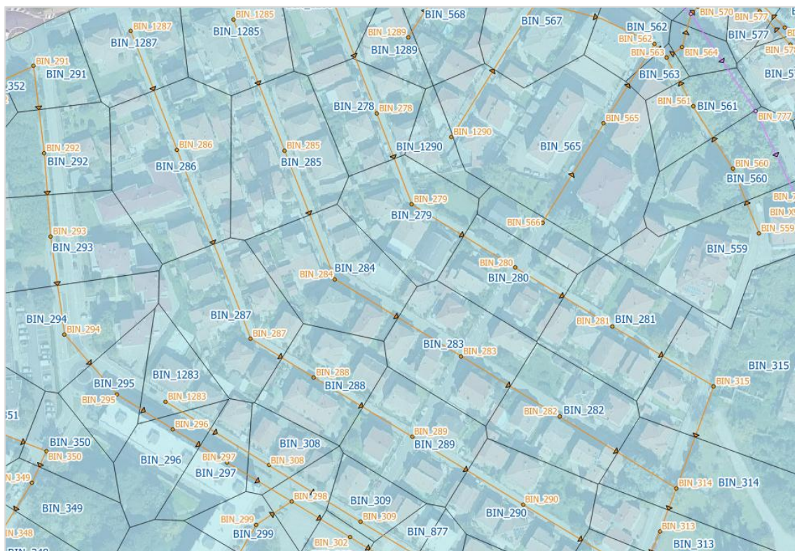
Figura 66 - Esempio estratto planimetrico definizione sottobacini (blu) afferenti ai nodi della rete (arancione) per il calcolo dell'area drenata dagli sfioratori.
